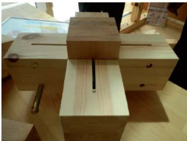
写真 33 金属製の板とピンを用いた「目につかない」機械的接合
