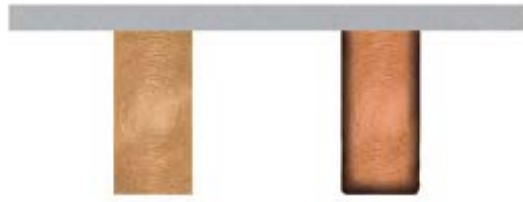
図7-火災の場合、焼け残った部分が構造部分を十分支持できる。
