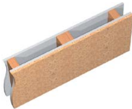
図6-石膏ボードで覆われた木材製の構造材
