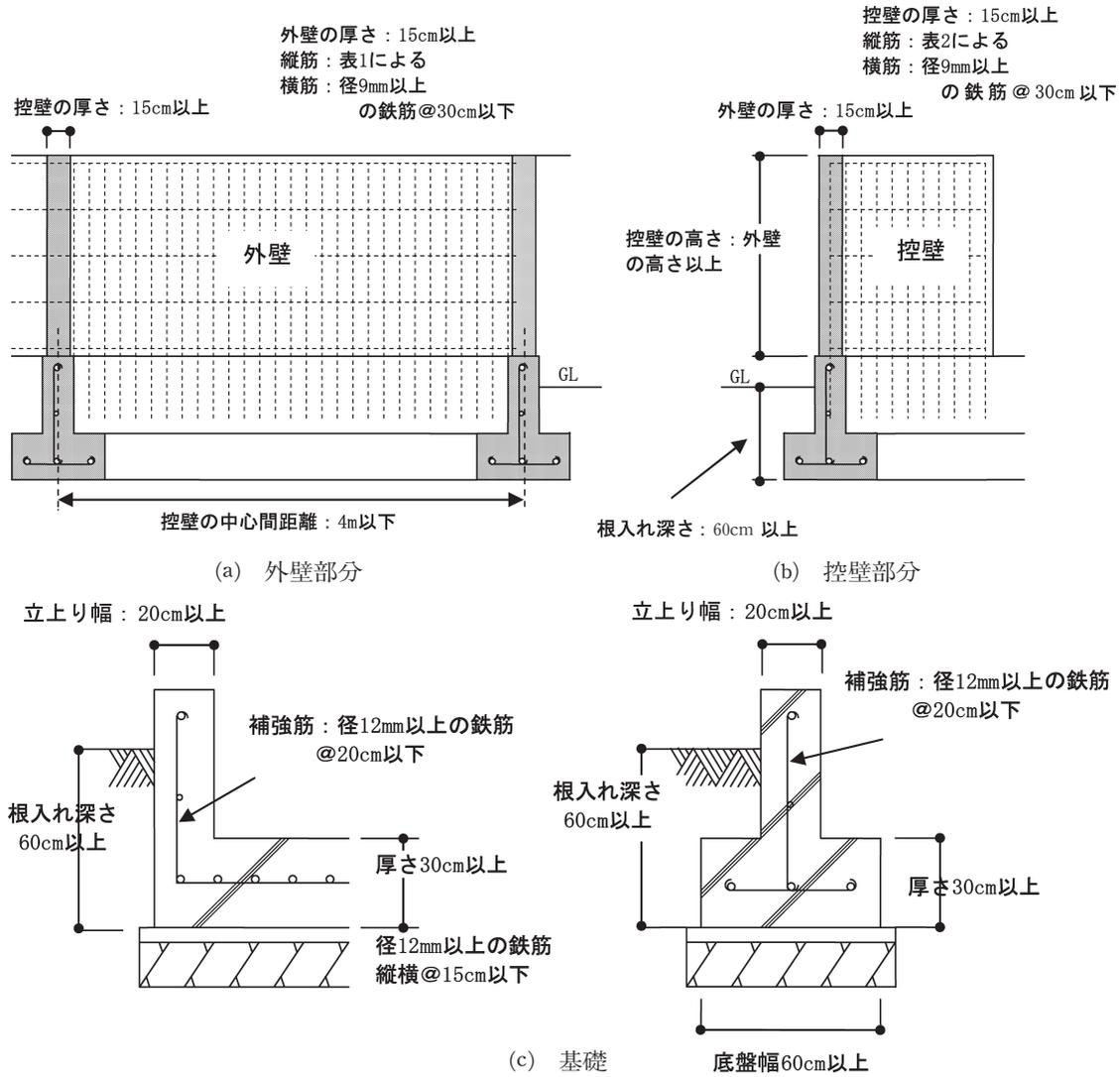
図3.11-2 第2第一号イ（控壁による場合）の構造<sup>17)</sup>
